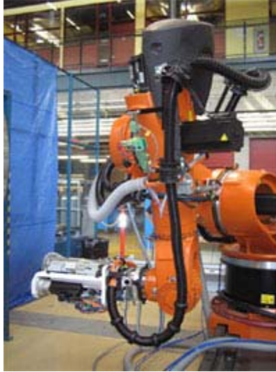
Un equipo industrial robótico de 500 kg está equipado con un perforador y un sellador para el ensamblado de paneles aeroespaciales.
